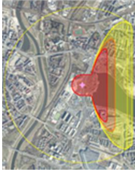
Rys. 2. Prezentacja przykładu stref zagrożenia przygotowana w aplikacji ALOHA dla: a) scenariusza 1 (strefa czerwona – AEGL-3 (60 min): 33000 ppm; strefa pomarańczowa – AEGL-2 (60 min): 17000 ppm; strefa żółta – AEGL-1 (60 min): 5500 ppm);
