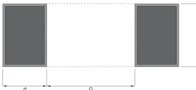
**Slika 3. 3. Skladišni modul za redno skladištenje bez opreme s paralelnim rasporedom paletiziranih LU**
